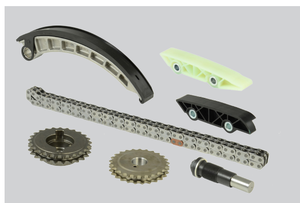
TCK195LNG: Łańcuch: duplex, zamknięty, 84 ogniwa
